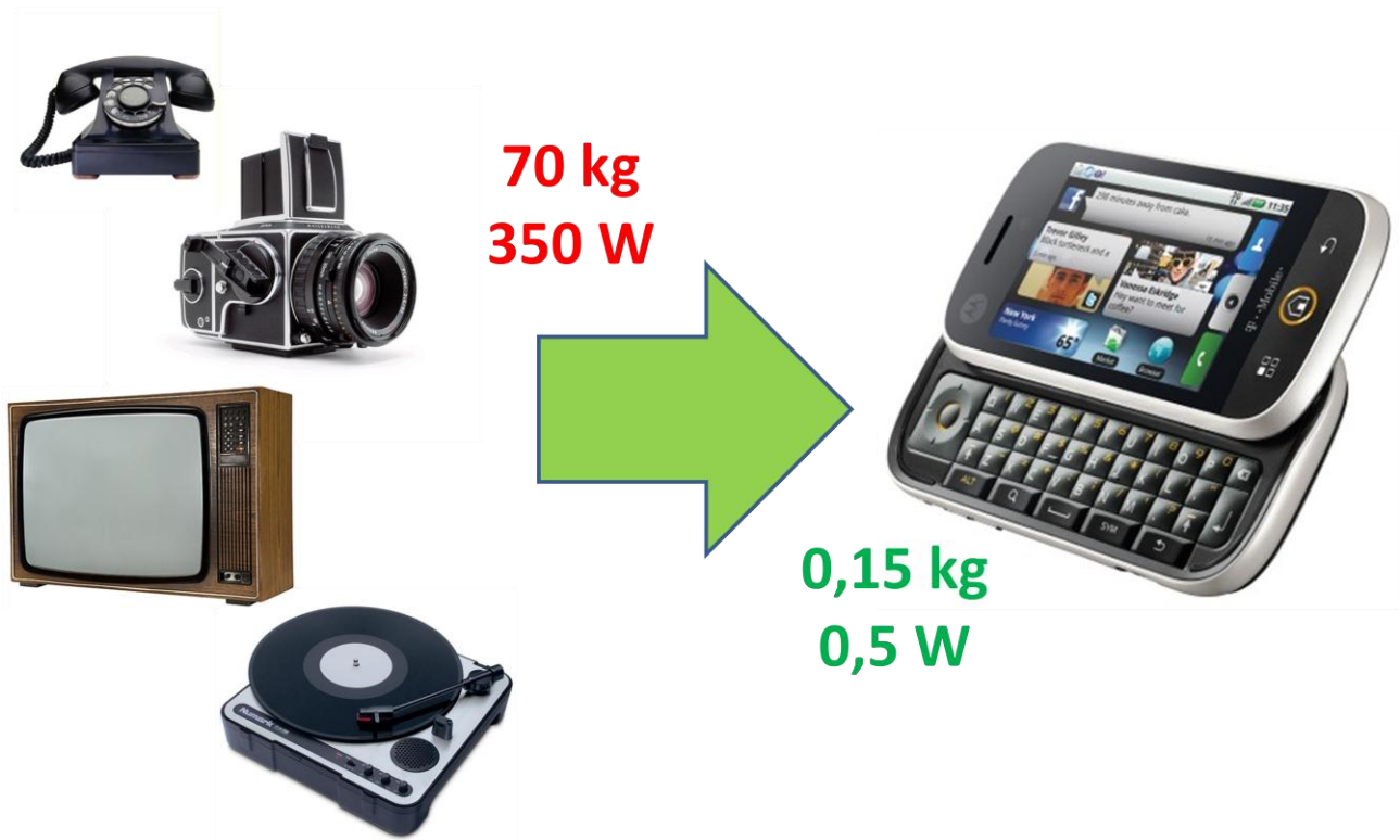
Kuva 46. Esimerkki teknologiamurroksesta, joka on johtanut myös tuotekonseptien täydelliseen murrokseen. Puhelimet, kamerat, televisiot ja levysoittimet muuttuivat ensin elektronisiksi ja digitaalisiksi entisten laitteiden tapaisiksi erillislaitteiksi. Kun ne olivat kehittyneet teknologialtaan yhte-neviksi, niistä syntyi uusi laitekonsepti, älypuhelin. Evoluutio on vähentänyt sekä laitteiden massan että energiantarpeen.
