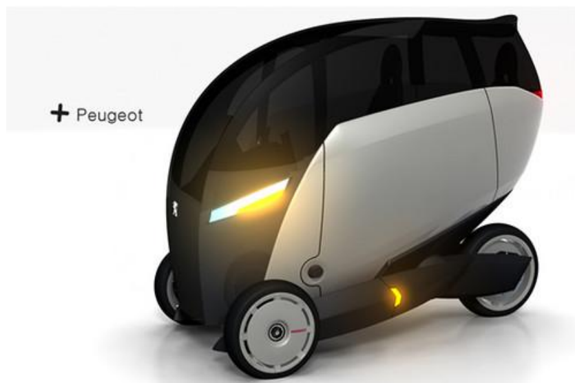
Kuva 44. David Vargasin designtutkielma nimellä Peugeot plus tehtynä vuoden 2007 Peugeot design kilpailuun. Tilaa on kahdelle henkilölle. Ajoneuvon pituus on 2,2 ja leveys 1,2 metriä. Kuvalähde http://psipunk.com/peugeot-brings-three-wheeled-eco-vehicles-to-style/
