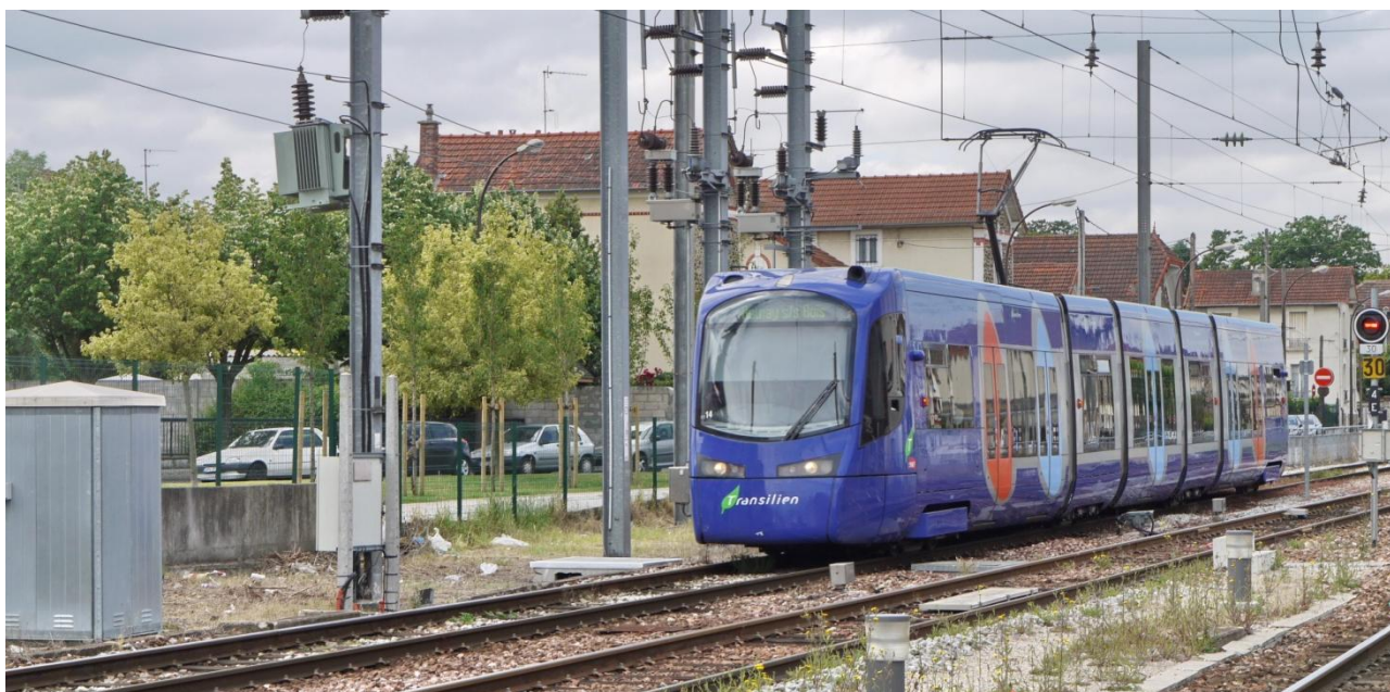
Kuva 8. Duoraitiovaunu rautatielinjalla Pariisin raitiolinjalla T4 kesäkuussa 2010. Siemensin valmistama vaunu Avanto S7 koostuu viidestä osasta ja on pituudeltaan 36,5 metriä.
