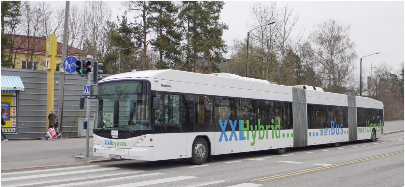
Kuva 11. Kaksinivelinen Hessin valmistama sarjahybridibussi koeliikenteessä Pitäjänmäellä toukokuussa 2010. Bussi on muunnos johdinautosta siten, ettei autossa ole virroittimia mutta takapäähän on sijoitettu aggregaatti ja katolle superkondensaattorit. Ajossa dieselmoottori on käynnissä jatkuvasti.
