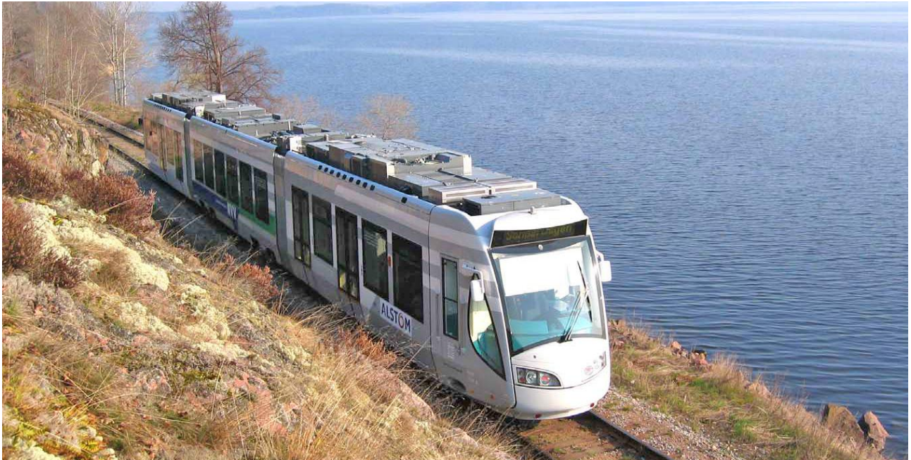
Kuva 9. Hybridiraitiovaunu sähköistämättömällä rautatieradalla Ruotsissa 2007. Alstomin valmistama Regio Citadis -mallinen vaunu on toimitettu Kasselin kaupunkiliikenteeseen. Kuva Alstom.
