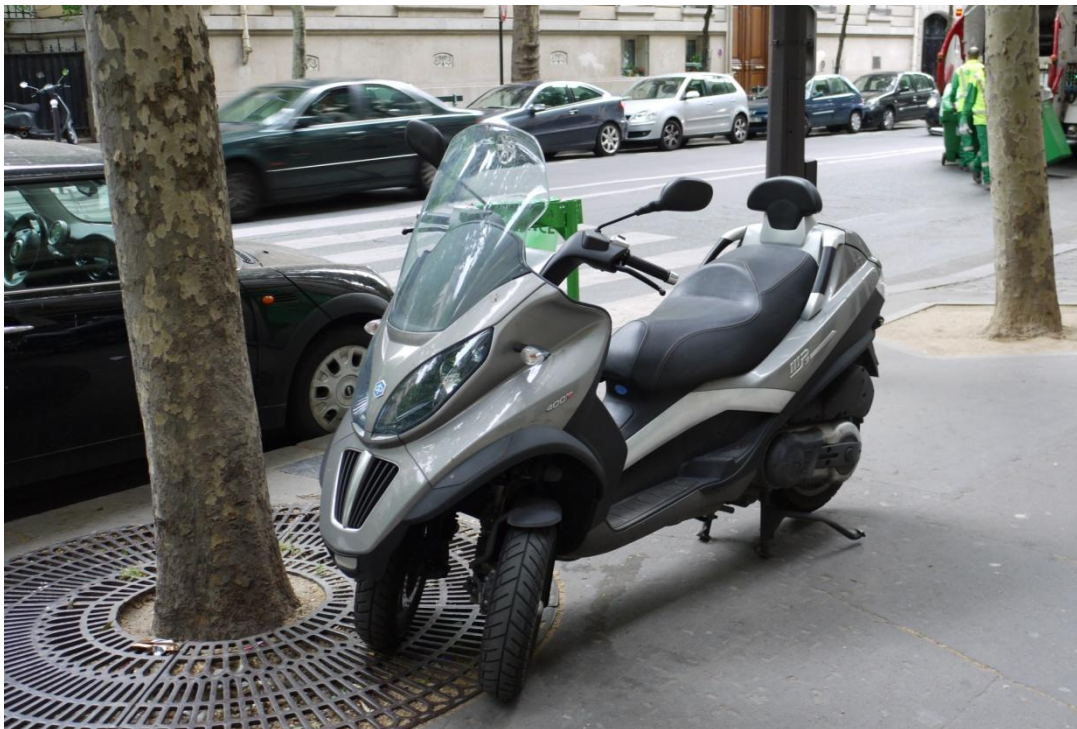
Kuva 38. Piaggion 3-pyöräinen skootteri. Malli on pysäköity tukijalalle nostettuna, vaikka pysäköitäessä etujousitus on lukittavissa pystyasentoon.
