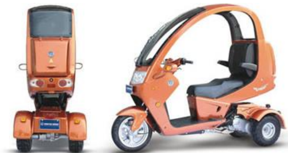
Kuva 40. Xingyun valmistama 3-pyöräinen osittain katettu skootteri XY150ZK. Laitteessa on tilaa kahdelle ja selkänojan takana on myös pieni tavaratila. Laitteen pituus on 2,2 ja leveys 0,67 metriä, omapaino on 160 kg. Kuvalähde Xingyu.
