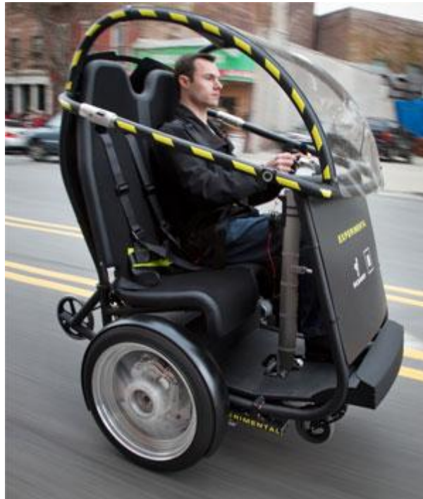
Kuva 42. Segwayn tekniikkaan perustuva 2-paikkainen yhden akselin ajoneuvon versio. Kuvalähde www.scientificamerican.com
