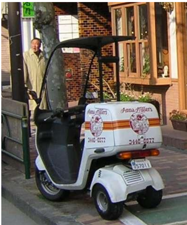
Kuva 39. Hondan Gyro-mopedin Canopy-mallin tuotanto alkoi 1990. Laitteeseen kuuluu tuulilasi ja katto sekä 62 litran tavaratila. Moottori ja voimansiirto muodostavat taka-akselin kanssa kokonaisuuden, joka on nivelletty kaksipyöräisten tapaan sivuttain taittuvaan runko-osaan. Kuvalähde Wikipedia Commons.
